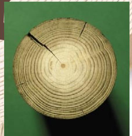
*druckimprägnierter Pfahl im Querschnitt*
